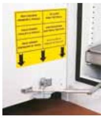
Pédale de blocage des portes en position ouverte équipée d'un thermo fusible calibré à 50 °C pour fermeture automatique des portes en cas d'incendie.
