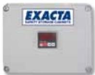
Alarme sonore, visuelle et téléphonique avec d'un thermostat digital équipé d'une sonde de température placée dans l'armoire. En cas de dépassement de la température de consigne, une alarme visuelle sonne sur l'armoire et appel un des 24 numéros de téléphone pré-enregistrés dans le système. Gamme de température: -40 à + 90 °C. Exactitude: +/- 1 °C. Résolution: 1 °C.
