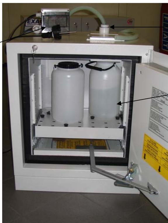
Connexion du tuyau d'évacuation des déchets à l'armoire et au bidon
