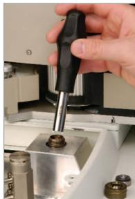
2) Placer l'extracteur sur le bouchon d'insert (les deux ergots entrant dans les deux encoches du bouchon).
