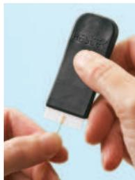
Maintenir fermement le tube d'une main (le tube doit dépasser de la main de 5 cm). Appliquer la lame contre le tube en respectant un angle de 45°. Faire glisser la lame sur le tube.
