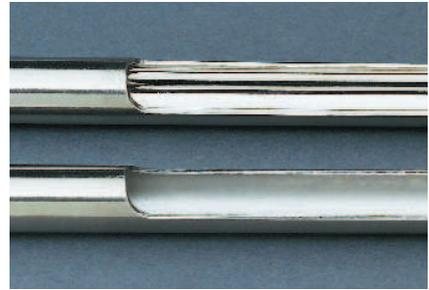
en haut : finition par électropolissage, rugosité moyenne de la surface : 5-10.
