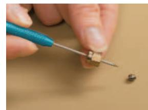
Pour chasser facilement et rapidement les ferrules coincées dans un écrou.
