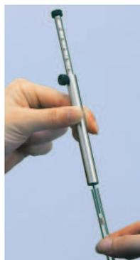
Desserrer l'écrou situé sur le côté du positionneur et régler la profondeur d'introduction suivant les spécifications de l'appareil.
