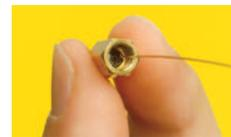
La ferrule est positionnée correctement et ne doit pas glisser sur la colonne. Introduire la colonne dans la source.
