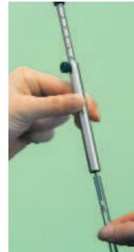
Insérer l'outil jusqu'à ce qu'il vienne buter sur l'extrémité de l'insert, puis le retirer. La laine est correctement placée et l'insert est prêt à être utilisé.
