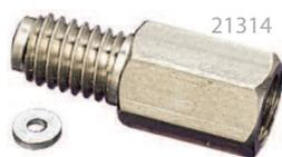
Dans l'interface MSD Agilent, l'étanchéité est assurée par le contact avec la ferrule à la fois du côté de la source MSD et de la colonne capillaire. Ce système est sujet aux fuites. Le raccord pour détecteur MSD Restek garantit deux points d'étanchéité, ce qui réduit les risques de fuites : la rondelle assure l'étanchéité entre le raccord MSD et la source et la ferrule assure l'étanchéité entre la colonne capillaire et le raccord.
