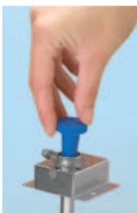
Enfoncer doucement l'extracteur dans l'insert d'injection en effectuant un léger mouvement de rotation.
