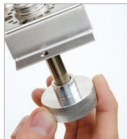
Un filetage usé ou endommagé n'assure plus une parfaite étanchéité. Une fuite peut fausser les résultats analytiques et endommager les colonnes.
