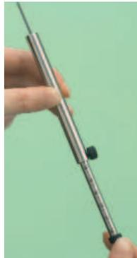
Desserrer l'écrou situé sur le côté du positionneur et régler la profondeur d'introduction suivant les spécifications de l'appareil.
