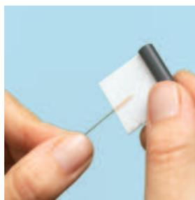
Maintenir le coupe-tube céramique de façon à ce qu'il forme un angle de 45° avec le tube. Appliquer une légère pression et un mouvement perpendiculaire régulier.
