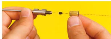
Enfiler l'écrou et la ferrule sur la colonne, insérer la colonne dans l'outil d'installation en laissant dépasser plusieurs centimètres à l'autre extrémité. Serrer l'écrou.
