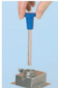
Replacer un nouvel insert dans l'injecteur à l'aide de l'extracteur.
