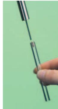
Placer un bouchon de laine non tassé de 5 à 7 mm à l'entrée de l'insert.
