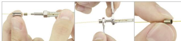
Introduire la colonne dans l'écrou et dans la ferrule, puis dans le positionneur jusqu'à la distance recommandée. Serrer l'écrou manuellement.
