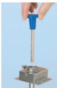
Replacer un nouvel insert dans l'injecteur à l'aide de l'extracteur.
