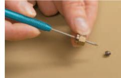
Pour chasser facilement et rapidement les ferrules coincées dans un écrou.
