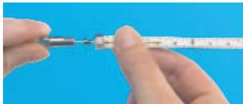
Introduire la colonne dans l'écrou et dans la ferrule, puis dans le positionneur jusqu'à la distance recommandée. Serrer l'écrou manuellement.
