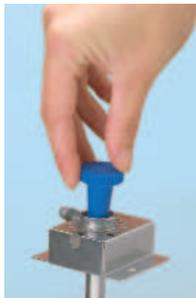
Enfoncer doucement l'extracteur dans l'insert de l'injecteur en effectuant un léger mouvement de rotation.
