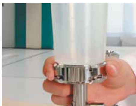
Fig. 9 (A). Fixation étanche de l'entonnoir et de la membrane permettant de réduire au minimum toute contamination croisée grâce à un système de fixation spécifique.
