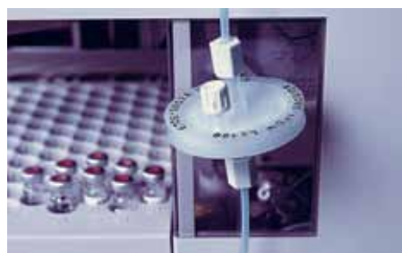
Fig. 7. Dégazeur de filtration en ligne de 50 mm IFD.
