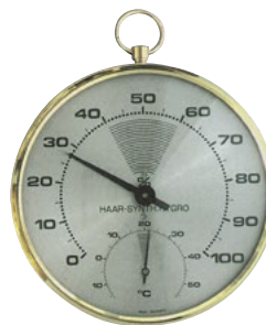
W 4200T • À cheveu ► -10° à +55°C ► 0 % à 100 %RH ► ABS couleur Laiton ► Ø 100 mm / 105 g
