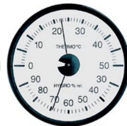
X 4503T • Bilame ► 0° à +50°C ► 30 % à 90 %RH ► ABS Ø 100 mm / 80 g
