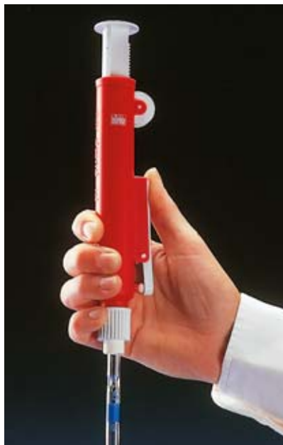
Écoulement du liquide par le levier. Il est notamment possible de prélever exactement des quantités minimales en tournant la molette
