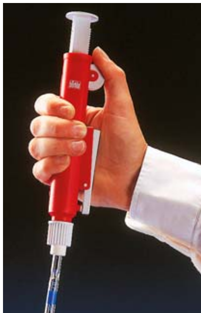
Aspiration via la molette. Dès que l'on arrête l'aspiration, le piston s'immobilise sans fuite de liquide
