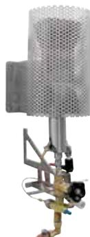
**Torche de brûlage** pour la postcombustion des gaz d'échappement. La torche est chauffée au gaz et fonctionne au propane. Elle est conseillée pour les processus dans lesquels il n'est pas possible d'utiliser un catalyseur.
