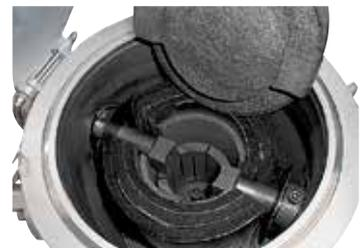
Module de chauffage au graphite
