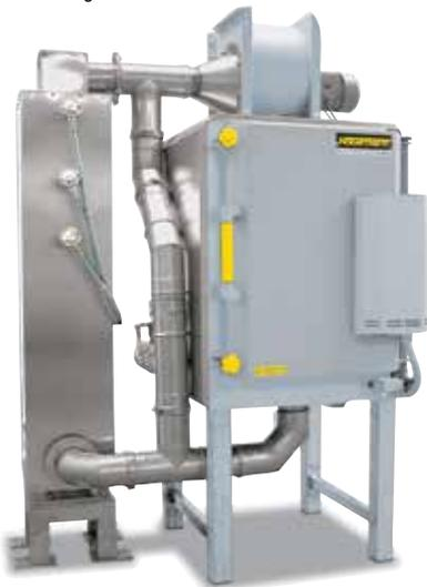
Four à chambre N 150/14 avec installation de postcombustion catalytique
