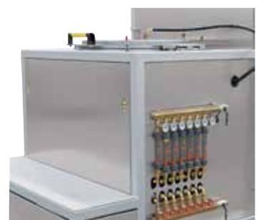
Système de contrôle de refroidissement à l'eau
