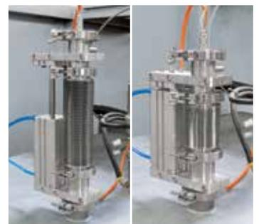
Thermocouple de type S avec dispositif d'extraction automatique autorisant de très bons résultats de régulation dans la plage inférieure de température
