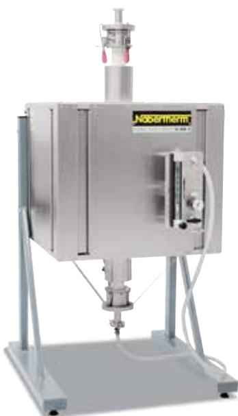
Four tubulaire vertical RHTV 120/150/17 avec support et ensemble d'alimentation en gaz 2 en option
