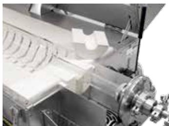
Pièces d'adaptation pour le fonctionnement avec tube de travail ou réacteur de process en alternance
