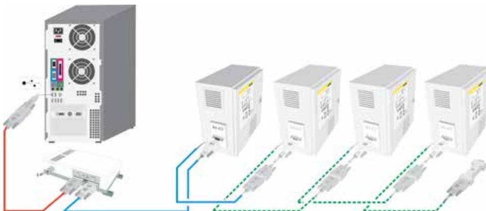
Extension pour raccordement de 16 fours maximum
