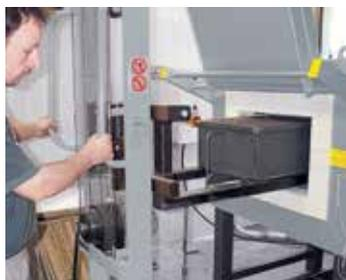
Travail avec caisson d'alimentation en gaz pour atmosphère gazeuse protectrice à l'aide d'un chariot de chargement
