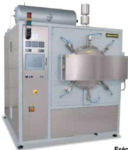
NR 200/11 H<sub>2</sub> pour le traitement thermique avec hydrogène
