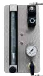
Système d'alimentation en gaz pour gaz protecteurs ou réactifs non combustibles
