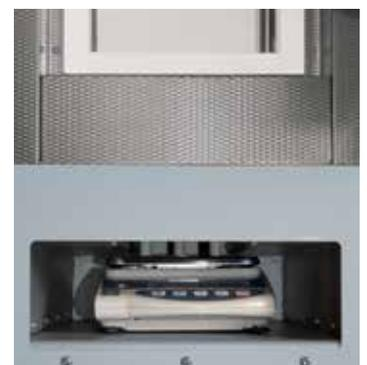
HT 16/17SW avec dispositif de pesée pour les dispositions sur les pertes au feu
