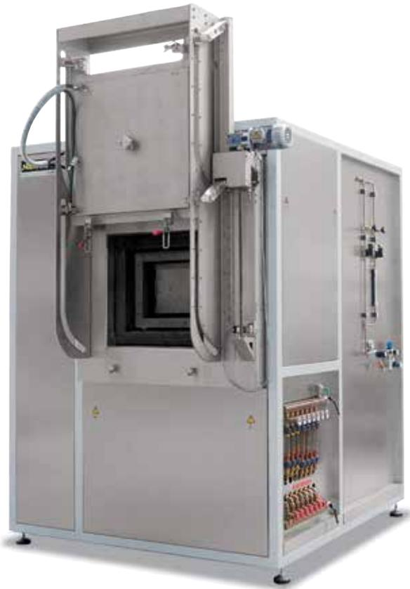
VHT 40/22 GR avec porte guillotine automatique et panneau frontal pour connexion sur caisson
