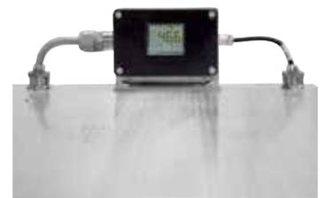
Mesure optique de la température pour permettre l'utilisation en four à passage
