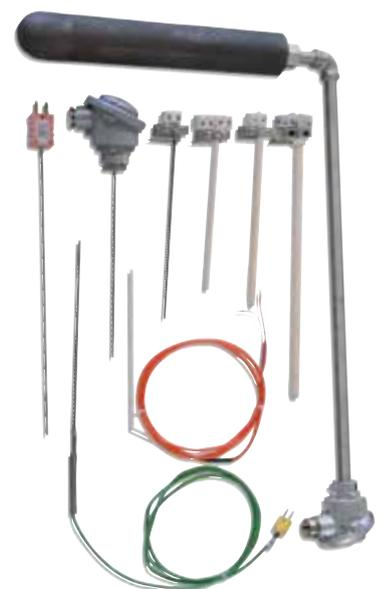
Différents modèles de thermocouples calibrés
