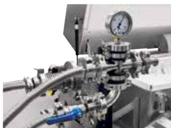
Kit de raccordement pour le fonctionnement sous vide
