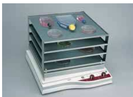
3013 Secoueur analogique à balancement avec plateau multi-étages 3968
