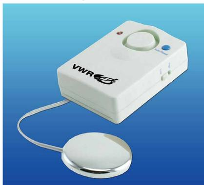
Peut être utilisée pour détecter les situations dans lesquelles le niveau de conteneurs, réservoirs, flacons ou béciers se rapproche du niveau de trop-plein. Au moment où une solution touche le capteur, l'alarme retentit et un voyant rouge clignote en continu jusqu'à ce que le liquide ne touche plus le capteur.
