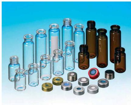
Flacons en verre transparent et ambré à fond plat ou arrondi et volumes de 5 à 20 ml, bouchons et outils. Un flacon à fond arrondi est plus robuste et résistant aux pressions élevées pendant le processus de chauffage. Les flacons à fond plat sont plus adaptés pour certains instruments.
