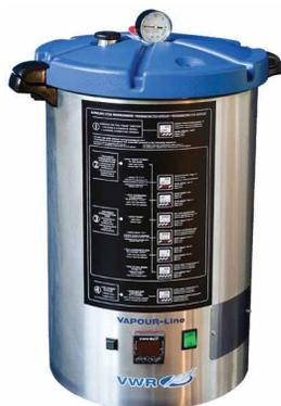
Boîtier en acier inoxydable AISI 340, facile à entretenir et à désinfecter, cuve intérieure en aluminium et couvercle isolant en ABS avec système de verrouillage.
