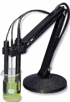
D'un maniement léger, il permet d'effectuer des mesures multiples avec rapidité et efficacité. Le bras orientable dans quasiment toutes les directions peut maintenir jusqu'à 4 électrodes + 1 sonde de température dans la position désirée en toute sécurité. Le porte-électrode monte, descend et pivote sans peine. Le bras est articulé au niveau des trois points de support de manière à pouvoir maintenir les électrodes en position verticale.
