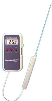
Sonde extérieure en acier inoxydable (LxØ: 178x3,5 mm avec câble de 45 cm)
