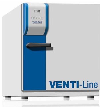
Ces étuves de séchage avec convection forcée sont conçues pour les applications de chauffage et de séchage de routine, lorsque des temps de séchage courts sont nécessaires. Elles sont équipées d'une aération ajustable à l'aide d'un clapet de ventilation et d'un conduit d'extraction de 50 mm Ø à l'arrière.
