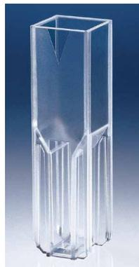
Cuves à usage unique en PS optique, avec une transmission optimale de 340 à 900 nm ou en PMMA (300 à 900 nm).
