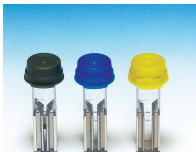
Les cuvettes d'électroporation VWR sont en polycarbonate transparent, de qualité médicale, et elles sont compatibles avec tous les électroporateurs classiques disponibles sur le marché. Disponibles dans 3 largeurs de fente pour répondre aux applications courantes - 1 mm pour la puissance de champ la plus élevée, adaptées aux bactéries; 2 mm pour la puissance intermédiaire; 4 mm pour la puissance la plus faible, adaptées aux cellules de mammifères et à certaines cellules de plantes.
