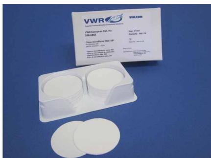
Ces membranes filtrantes en fibre de verre exemptes de liant assurent des débits rapides, une capacité de chargement élevée, une tolérance thermique importante et une excellente rétention des précipités.
