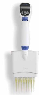
Micropipettes légères et ergonomiques, permettant d'éviter toute fatigue de la main suite à des opérations répétées. Elles sont équipées d'un moteur pas à pas commandé par microprocesseur afin de distribuer des volumes extrêmement précis à l'aide du piston, et d'un coupleur optique qui suit la position du piston pour garantir la répétabilité du mouvement à chaque utilisation.
