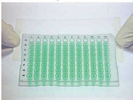
Film de 50 µm en polyoléfine avec adhésif encapsulé de 50 µm en silicone inerte. Convient particulièrement aux applications de qPCR en temps réel, stockage et cristallisation de protéines. L'adhésif en silicone encapsulé n'adhère pas jusqu'à être pressée contre la surface à sceller. Ce scellage forme dès lors une zone très étanche qui résiste à la chaleur, autour de chaque puits de la plaque.
