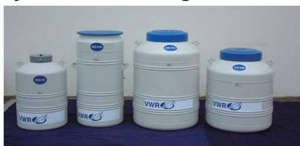
Les réservoirs de la série BSS offrent diverses solutions pour le stockage de flacons ou de paillettes en phase liquide ou gazeuse. La température est uniforme, même lorsque le niveau d'azote liquide au-dessus de l'isolateur du portoir n'est plus que de 2 cm (5 cm au-dessus du fond pour le BSS-5100).
