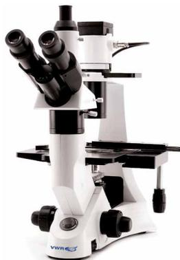
Le microscope inversé VisiScope IT 404 est équipé d'objectifs adaptés aux applications standard de culture cellulaire in vivo. Les commandes de mise au point permettent de poser les poignets sur la table. La platine surmontée d'une plaque de verre permet de voir les objectifs pour identifier l'agrandissement.
