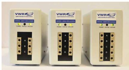
Un dégazage en ligne est plus efficace pour éliminer le gaz dissous dans les phases mobiles que la sonification ou le barbotage d'hélium. Jusqu'à cinq canaux de solvant peuvent être dégazés simultanément par un appareil. Le très faible volume de chaque canal en PTFE AF (480 µl) permet un équilibrage et un temps de démarrage rapides.
