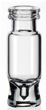
Les flacons microlitre sont dotés d'un fond à cône interne précis permettant une récupération maximale sans utiliser de micro-insert séparé. Ils assurent une récupération maximale pour les systèmes GC et HPLC/UHPLC, avec un volume résiduel de <math><1 \mu\text{l}</math>.
