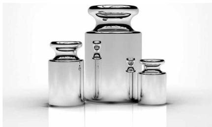
Poids en acier inoxydable, ASTM classe 1, pour le contrôle précis et l'étalonnage de balances électroniques.
