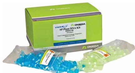
Le kit E.Z.N.A.<sup>®</sup> SP Plant DNA est spécifiquement conçu pour l'isolation rapide et fiable d'ADN cellulaire total de haute qualité à partir d'un grand nombre d'espèces de plantes. Jusqu'à 100 mg d'échantillons frais ou 30 mg d'échantillons secs peuvent être traités en moins de 40 minutes. L'ADN purifié convient pour la plupart des applications en aval, dont PCR, digestions par des enzymes de restriction et techniques d'hybridation.
