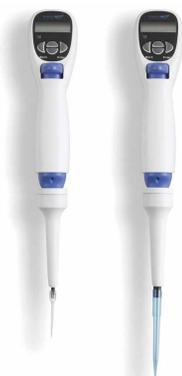
Micropipettes légères et ergonomiques, permettant d'éviter toute fatigue de la main suite à des opérations répétées. Elles sont équipées d'un moteur pas à pas commandé par microprocesseur afin de distribuer des volumes extrêmement précis à l'aide du piston, et d'un coupleur optique qui suit la position du piston pour garantir la répétabilité du mouvement à chaque utilisation.
