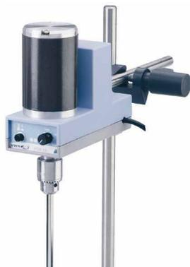
Cet agitateur à hélice électronique est économique et silencieux. Il convient aux applications simples de mélange en laboratoire telles que le traitement de milieux à fortes variations spontanées de viscosité. Idéal pour l'agitation de substances de faible à moyenne viscosité. La régulation électronique de la vitesse permet de la maintenir constante, même en cas de changement de viscosité. Le mandrin accepte des tiges à hélice de diamètre 8 mm max.
