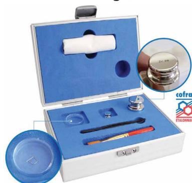
Gamme économique de jeux d'étalonnage, avec uniquement 3 poids en acier inoxydable, afin de satisfaire aux exigences d'étalonnage de routine des balances de précision et analytiques.
