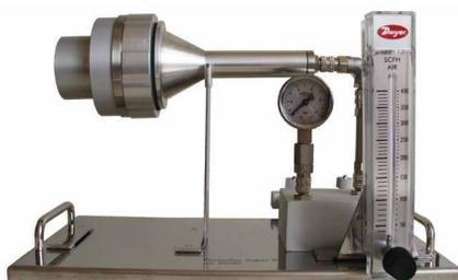
Le Pinocchio Super II est un préleveur d'air microbien avec impact permettant de tester la qualité microbiologique de l'air et des gaz comprimés utilisés dans les salles blanches. Une source d'air comprimé est reliée au système Pinocchio Super II et le débitmètre est réglé pour atteindre le débit requis, par ex. : 100 litres d'air/minute. Le temps de prélèvement est chronométré afin d'obtenir le volume d'échantillon total requis, par ex. 1000 litres.
