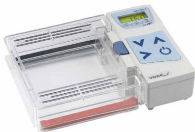
Le Mini Gel II est un système d'électrophorèse complet comprenant tous les composants nécessaires au coulage et au traitement de gels horizontaux: plateaux pour gels, peignes, support de coulage, cuve de migration et alimentation.
