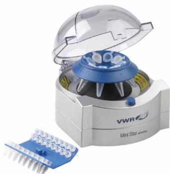
Idéale pour toutes les applications qui ne demandent pas une vitesse de rotation très élevée, comme par ex. la microfiltration et la séparation cellulaire. Elle peut être utilisée en chambre froide. La centrifugation débute lors de la fermeture du couvercle et s'arrête par une pression sur le bouton couvercle. Un bouton on/off permet un fonctionnement continu.
