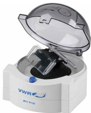
Idéale pour sécher les lames de microscopie. Elle peut être utilisée en chambre froide. La centrifugation débute lors de la fermeture du couvercle et s'arrête par une pression sur le bouton couvercle. Un bouton on/off permet un fonctionnement continu.
