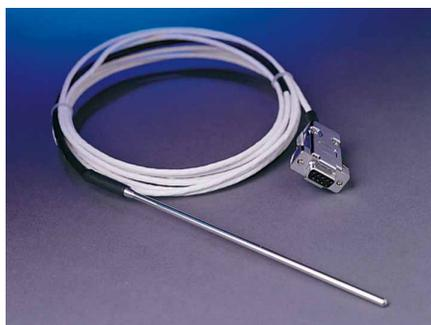
Sondes de température à distance pour circulateurs avec contrôleur programmable. Permettent l'utilisation d'un point de contrôle à distance, par exemple dans une cuve ouverte. Compensent la perte de chaleur via un tuyau reliant le circulateur au point de contrôle. Sonde RTD en platine recouverte d'une gaine en acier inoxydable. Couplage en caoutchouc de 25,4 mm de Ø, connectant la gaine au câble souple. Le câble de la sonde se termine par une prise femelle DB9.
