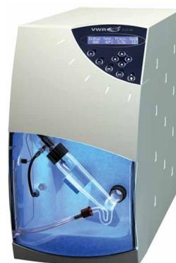
Ces détecteurs incluent de nombreuses fonctionnalités innovantes, notamment la possibilité de sélectionner le nébuliseur le mieux adapté et une technologie LT unique. La conception du tube de glissement à l'évaporation optimise la résolution et la sensibilité. En outre, le contrôle du système peut s'effectuer au niveau local ou via un PC. Un mode d'arrêt à distance est fourni pour minimiser les coûts et optimiser la durée de vie du système.
