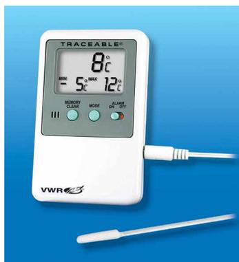
Capteur de température à tampon (LxØ: 19x8 mm) avec microcâble de trois mètres
