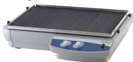
Agitateur à usage intensif commandé par microprocesseur, particulièrement adapté aux mélanges à charges lourdes, par ex. suspensions bactériennes, coloration ou décoloration. La commande à vitesse variable assure une agitation constante et uniforme. Une molette réglable de 1 à 10 permet d'ajuster la vitesse ; pour plus de sécurité, les agitateurs accélèrent progressivement jusqu'à la valeur programmée.
