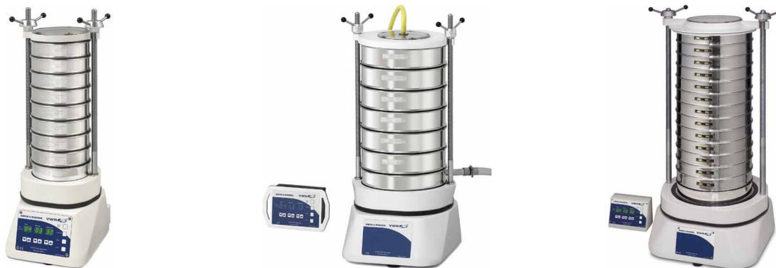
Les trois modèles de tamiseuses de test électromagnétiques sont conçus pour l'analyse de tamisage avec action de tamisage optimale en trois dimensions. Le réajustement automatique de l'amplitude, qui utilise la mesure d'accélération permanente de toute la tour de tamisage, équilibre l'oscillation de l'appareil et son pied. Cela permet de maintenir les amplitudes, quelles que soient la quantité d'alimentation et la position de l'installation.
