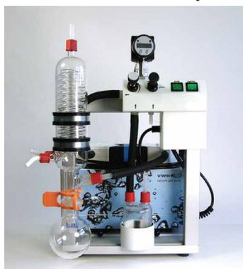
Ces systèmes de vide sont tout à fait adaptés au contrôle des processus dans un évaporateur rotatif. Le système fermé breveté permet une distillation douce et des taux de récupération élevés de solvants, même avec des points d'ébullition bas. Idéal pour une utilisation avec l'évaporateur RV10 VWR Collection.
