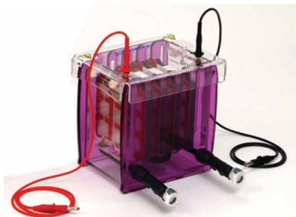
L'unité d'électrotransfert VWR Collection est conçue pour simplifier et sécuriser le transfert des protéines ou acides nucléiques d'une matrice de gel sur une membrane de transfert appropriée. Elle peut être utilisée pour transférer jusqu'à quatre gels de 10x10 cm.
