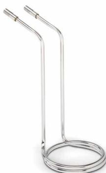
Pour le refroidissement auxiliaire de thermostats à circulation VWR. Une fois connecté à une arrivée d'eau, le serpentin en acier inoxydable assure un refroidissement rapide ou un meilleur contrôle en cas de fonctionnement à température quasi-ambiante. Non recommandé pour une utilisation dans un bain à circulation avec des liquides dont la température est supérieure au point d'ébullition de l'eau.
