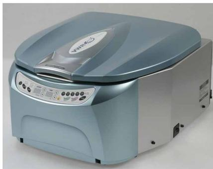
Centrifugeuses de paille universelles au design innovant avec différentes options (rotors et godets) pour diverses applications. Les modèles CT6E et CT6EL avec rotor libre ont une capacité maximale respective de 1000 ml (4x250 ml) et de 2000 ml (4x500 ml).
