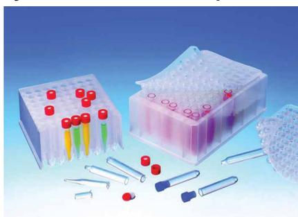
Systèmes à 96 puits (Ritter) avec inserts en verre, utilisés en chimie combinatoire lorsque le bloc en PP pur n'est pas suffisamment inerte. Les inserts peuvent être fermés au moyen de capsules en PE ou sur toute la surface du bloc par un film de scellage Sealmat en silicone avec un film en PTFE.
