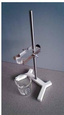
Ce support permet la fixation de deux électrodes.
