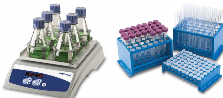
Agitateur à usage général commandé par microprocesseur, particulièrement adapté à une large gamme d'applications de mélange. La commande à vitesse variable assure une agitation constante et uniforme. La vitesse peut être ajustée par incréments de 10 min<sup>-1</sup> jusqu'à 500 min<sup>-1</sup> et par incréments de 25 min<sup>-1</sup> jusqu'à 900 min<sup>-1</sup>. Pour plus de sécurité, les agitateurs accélèrent progressivement jusqu'à la valeur programmée.
