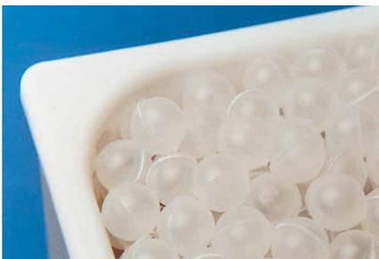
Billes légères et économiques en PP formant une couche d'isolation sur la surface du liquide des bains. Les billes ont un Ø de 20 mm, 275 billes recouvrent une surface d'environ 1 000 cm<sup>2</sup>.
