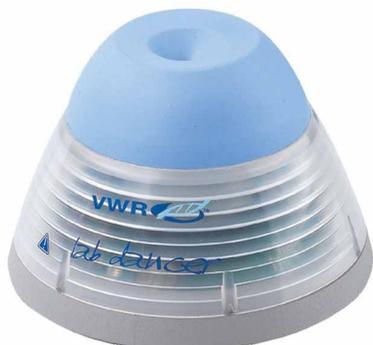
Agitateur type vortex pour petits conteneurs de diamètre 30 mm maximum, par exemple tubes à essai, tubes à centrifuger, tubes Eppendorf. Boîtier en PP, support en plastique inerte TPU, base en zinc moulé sous pression.
