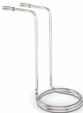
Pour le refroidissement auxiliaire de bains thermostatés VWR. Une fois connecté à une arrivée d'eau, le serpentin en acier inoxydable assure un refroidissement rapide sur des températures élevées ou un meilleur contrôle en cas de fonctionnement à température quasi-ambiante. Non recommandé pour une utilisation dans un bain dont la température du liquide est supérieure à la température d'ébullition de l'eau.
