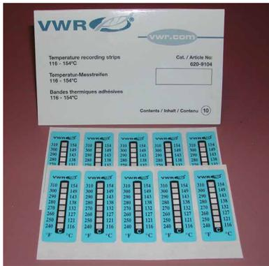
Ces indicateurs sont conçus pour des mesures rapides difficiles à pratiquer avec des thermomètres conventionnels. Ils conviennent pour un usage avec des équipements tels que des chambres de chauffage et des produits sensibles à des températures élevées.
