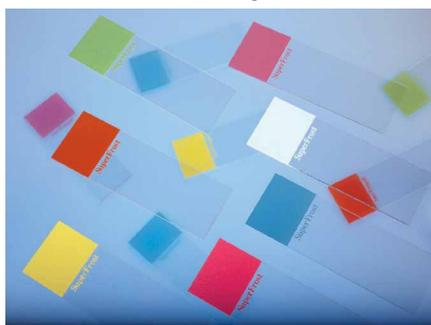
Les lames de microscope SuperFrost® sont dotées d'un revêtement légèrement opaque dans différentes couleurs. Chaque couleur permet de coder les échantillons en fonction des urgences, du traitement et de la technique de coloration.
