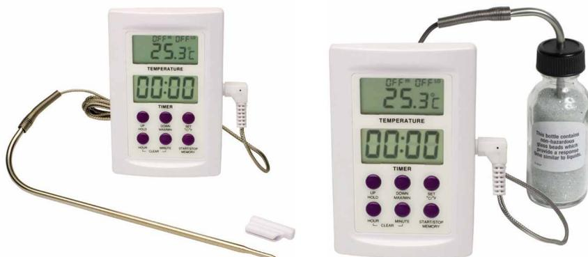
Sonde (150 mm) avec câble d'un mètre/Flacon de billes de verre
