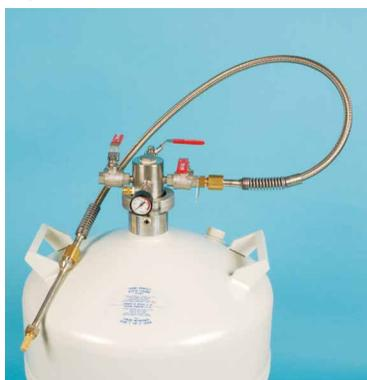
**478-0296:** tête de prélèvement de base: peut être reliée à n'importe quel modèle équipé d'une bride PNEUROP NW50. Il est possible de prélever de petites quantités d'azote liquide du vase Dewar jusqu'à ce que la pression intérieure du conteneur atteigne la pression ambiante.
