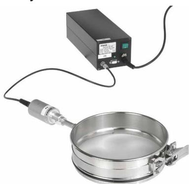
L'utilisation de la variation de fréquence ultrasonique pour le tamissage test permet même de tamiser des poudres présentant des coupes de séparation  $\leq 300$  microns. Il suffit pour cela de grouper au moins une tamiseuse de test HAVER avec un système de variation de fréquence.
