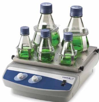
Agitateur à usage général commandé par microprocesseur, particulièrement adapté aux mélanges de base, aux suspensions bactériennes, à la coloration et à la décoloration. La commande à vitesse variable assure une agitation constante et uniforme. Une molette réglable de 1 à 10 permet d'ajuster la vitesse ; pour plus de sécurité, les agitateurs accélèrent progressivement jusqu'à la valeur programmée.
