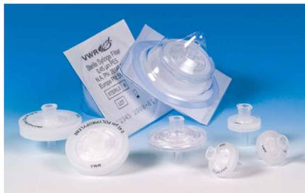
Les membranes de seuil de filtration de 0,2  $\mu\text{m}$  sont utilisées pour la filtration stérilisante. Celles de 0,45  $\mu\text{m}$  conviennent pour les applications de chromatographie.
