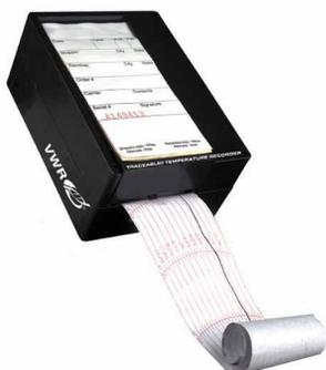
Ces enregistreurs permettent de surveiller les températures dans les réfrigérateurs, les incubateurs, les entrepôts, les chambres froides et sites de production de substances chimiques et matériels biologiques. Enregistrement sur graphe de longueur 90 cm.
