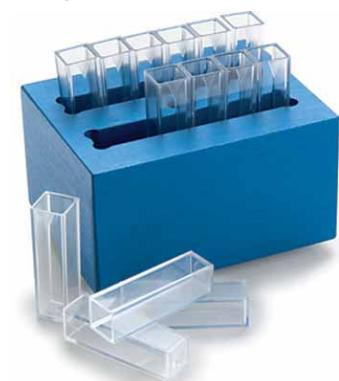
Deux fentes parallèles accueillent 6 cuvettes chacune, côte à côte, pour une stabilité et un transfert thermique excellents.
