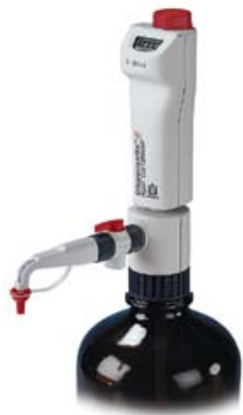
3. Retirer le bouton rotatif rouge et régler sur la valeur réelle obtenue (9,90 ml pour notre exemple).
