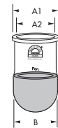
Rohfaser-Extraktionshülsen mit Flansch für System Tecator® und andere Filter-Thimbles for dietary fibre extraction with flange for system Tecator® and others
